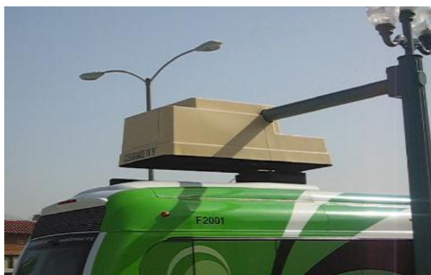
KUVA 6: "FastFill™" - latausjärjestelmän anturi (kuva: Veolia Environment R&I, Werner Nuchterlein)
